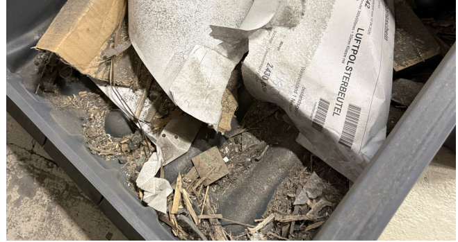
Inhalt des Schmutzfangbehälters: Kartonreste, Holzsplitter, Umreifungsband und Staub
