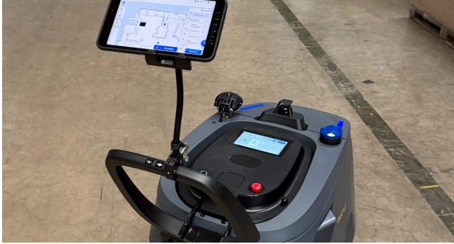
Beim initialen Mapping wird die Halle einmal abgefahren; die Karte entsteht am Tablet
